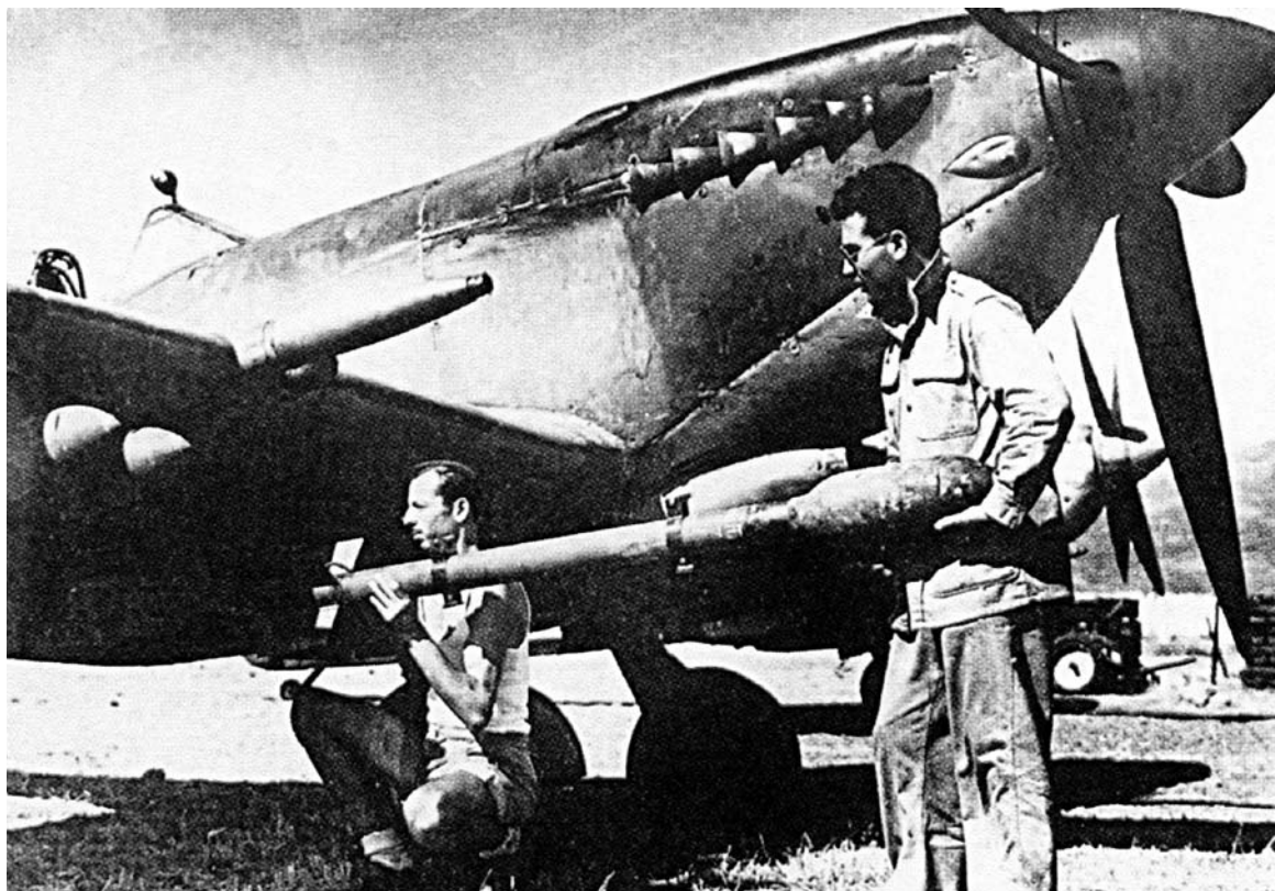
Φόρτωση ρουκετών HVAR των 5 ιντσών σε αεροπλάνο Δ/Β τύπου Vickers Supermarine Spitfire της ΕΒΑ (Αρχείο Πολεμικού Μουσείου Αθηνών).
