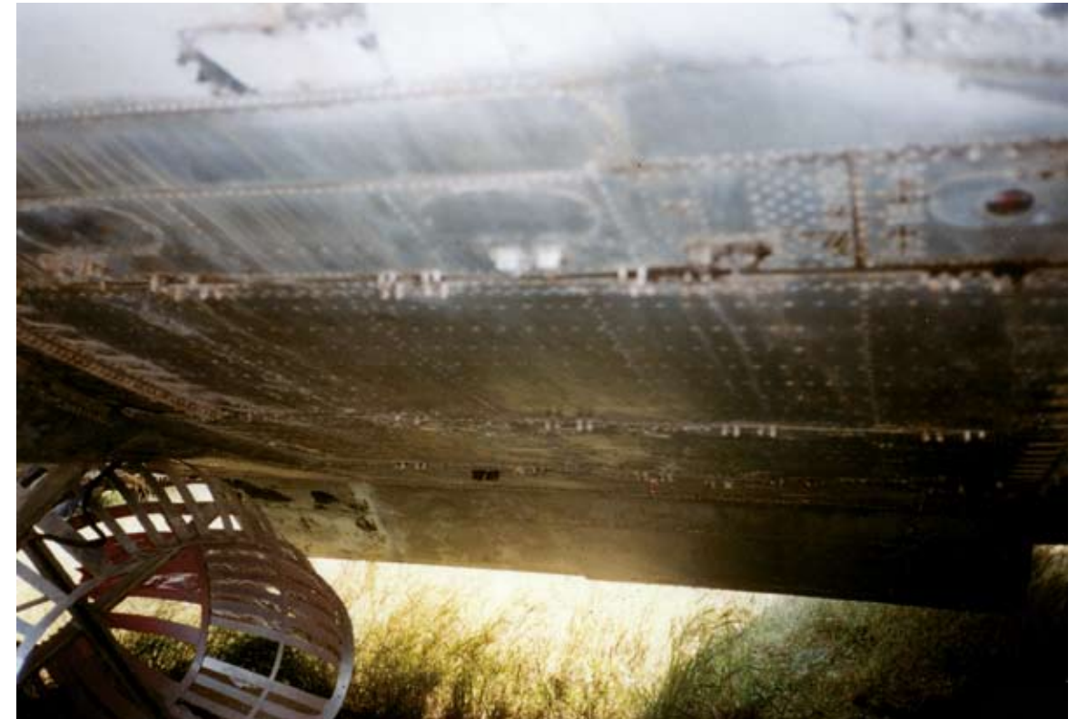
Λεπτομέρεια του κάτω μέρους, τμήματος της δεξιάς πτέρυγας του υπό ΔΝΚ: ΚΚ-169 βομβαρδιστικού Douglas C-47/DC-3 «Dakota». Είναι εμφανή τα σημεία προσαρμοσής, των εξωτερικών φορέων, αναρτήσεως βομβών (Αρχείον ΕΕΕΣ Α.Ε. «Κηρύκειον»).
